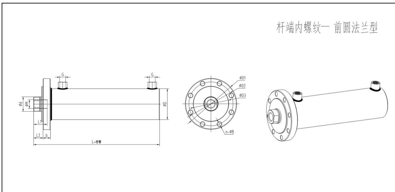
杆端内螺纹-前圆法兰型
